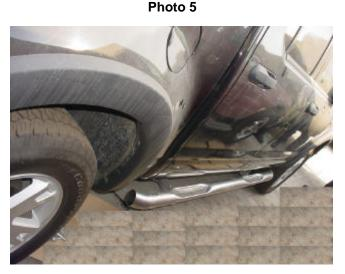
SIDEBAR INSTALLED, PASSENGER SIDE.
